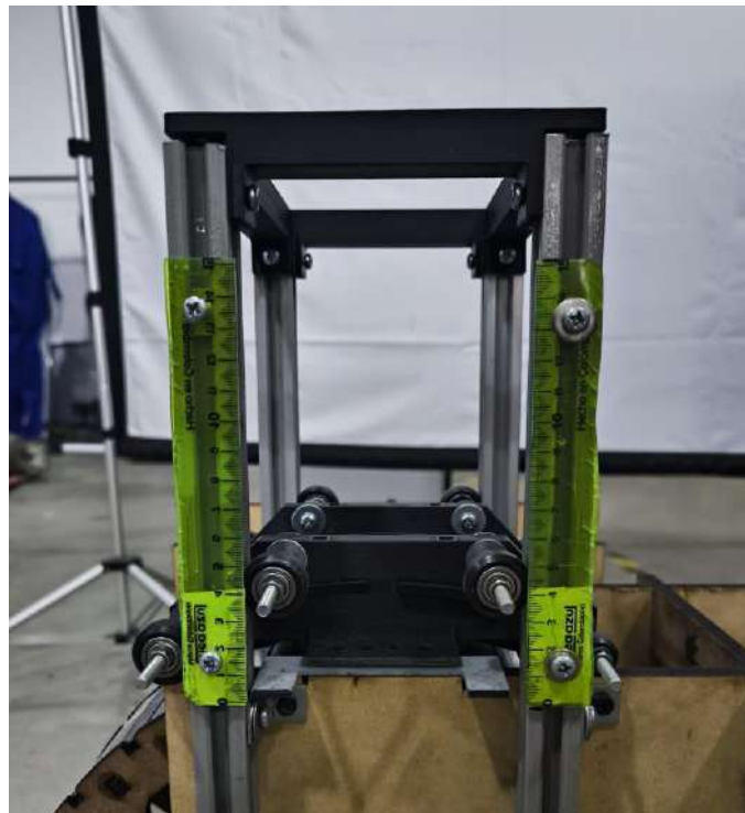
Figura 14. Montaje prototipo robusto con arreglo Halbach curvo.
