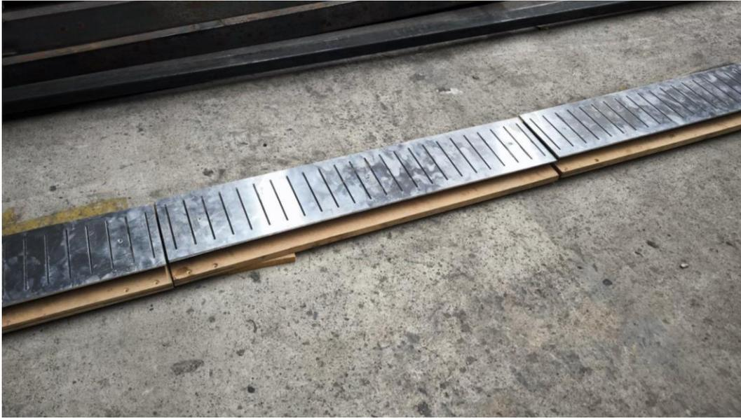
*Figura 19. Secundario motor lineal "Via"*
